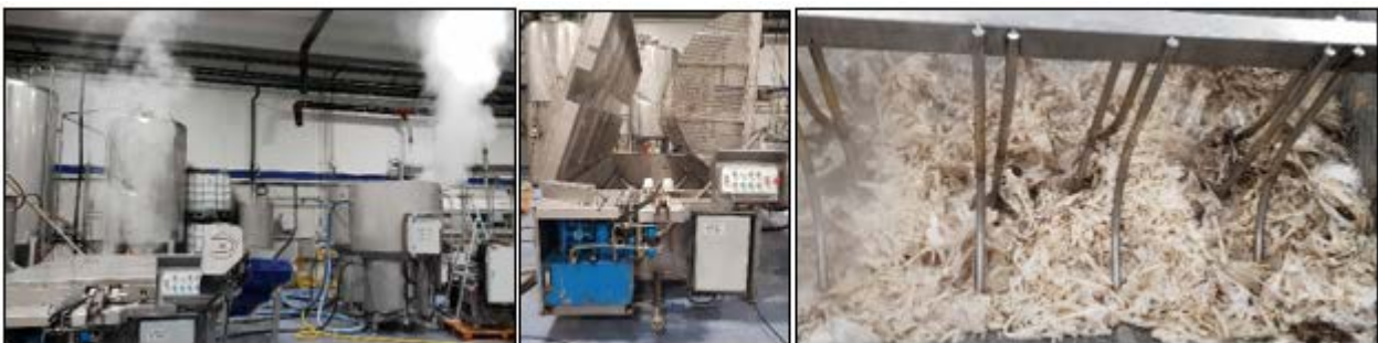
Figur 2: En liggende, nyutviklet, hydrolysereaktor ble testet i PRIMAprtein prosjektet.
